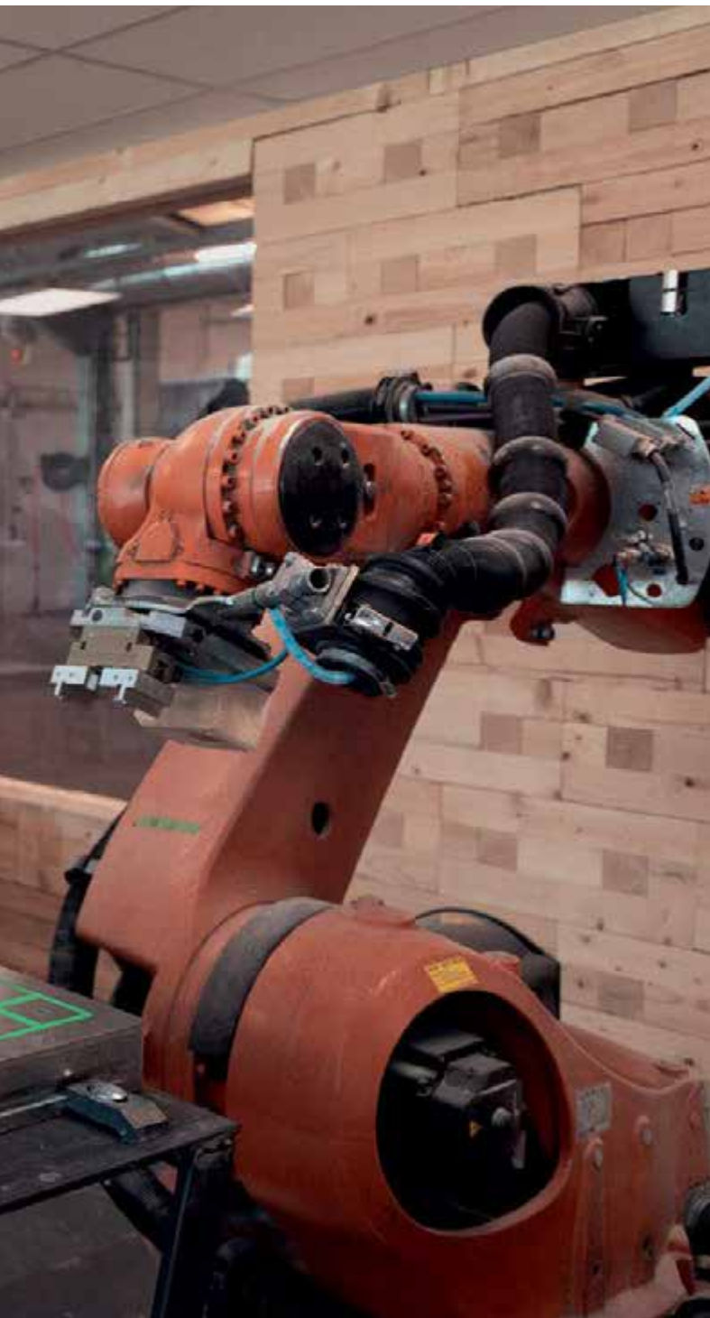
Oben: Bundesminister Cem Özdemir besuchte Triqbriq in Tübingen im Zuge einer Förderbescheidübergabe und testete das System direkt selbst. Links: „Triqbriq“-Bausteine werden mit Robotertechnik gefertigt: hochpräzise, schnell und kostengünstig. Das Material ist Schwach- und Schadholz (unten).
