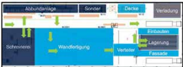
Oben: So können schematische Fertigungslayouts mit angedeutetem Fertigungs- bzw. Materialfluss einer Produktionshalle aussehen. Erst wird grob und dann immer feiner geplant. Anschließend geht es um Details, wie beispielsweise die Konzeption einzelner Arbeitsschritte.
